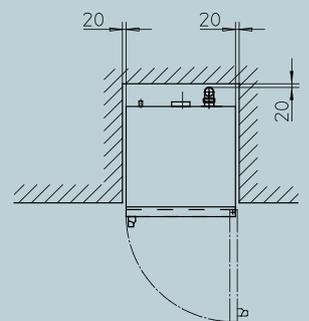
1 Abluft 50 mm 2 Anschluss Strom 3 Anschluss Wasser 3/4" 4 Ablauf
