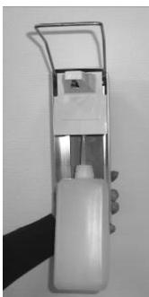
1. Drücken Sie den Seifenbehälter nach oben und ziehen ihn nach vorne aus dem Gehäuse heraus. Befüllen Sie ihn mit einer handelsüblichen Flüssigseife.
